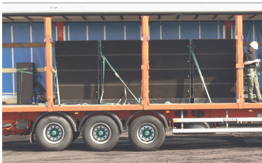
Figuur 10. Kunstbron: array van 16 luidsprekers op een vrachtwagen.
